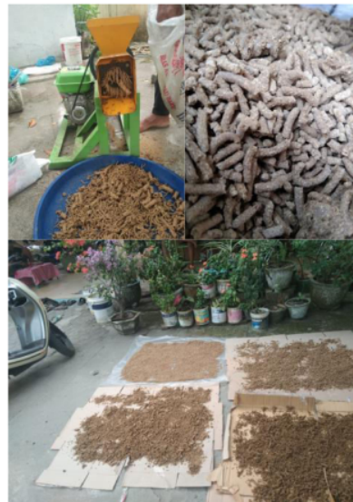
Gambar 5. Penggilingan & pengeringan pakan
