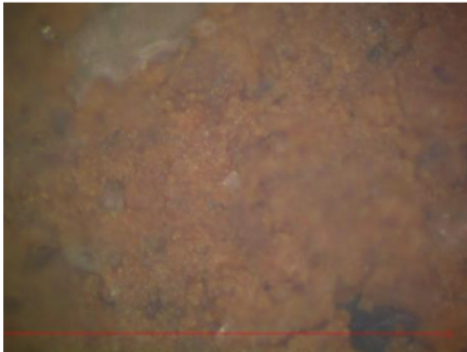
Gambar 5. Struktur morfologi sampel 90% cangkang kerang 10% pasir kuarsa
